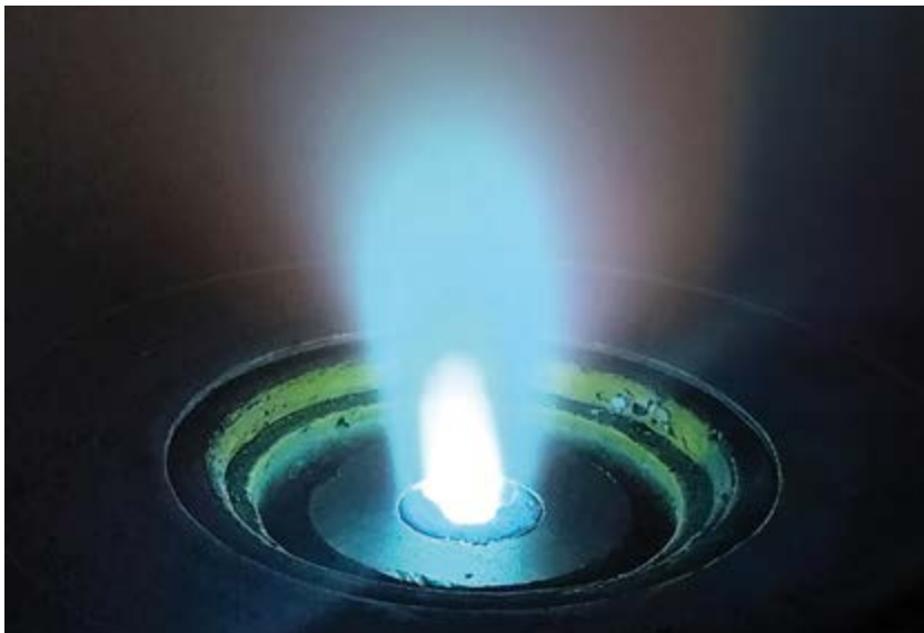
Verdampfung von Cäsiumjodid mit dem anodischen Bogen. (Bild: Fraunhofer FEP)
