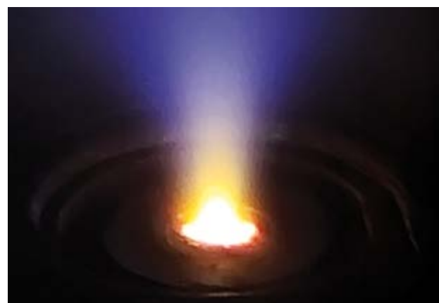
Verdampfung von Zinnoxid mit dem anodischen Bogen. (Bild: Fraunhofer FEP)
