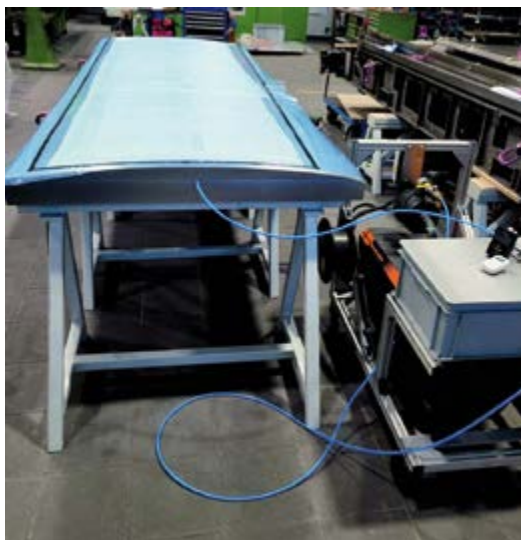
Bei der Herstellung von CFK-Bauteilen muss die Luft aus der Form entzogen werden. Den Prozess kontrolliert bei Grunewald das Vakuummeter VD810. (Bild: Thyracont)
