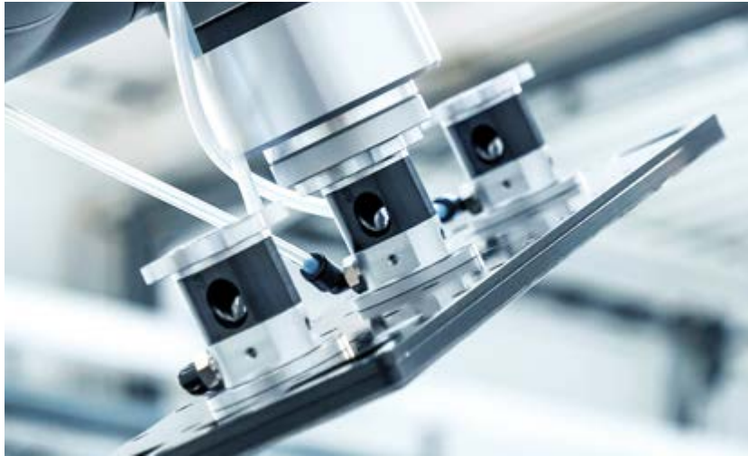
Vakuum ist nicht nur als Prozessumgebung wichtig, sondern auch im Bereich der Handhabung sensibler Bauteile wie zum Beispiel Bipolarplatten unverzichtbar. (Bild: Schmalz)
