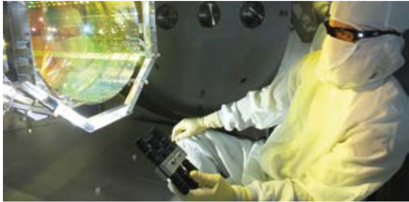
Spiegelbeschichtungen für Gravitationswellendetektoren müssen höchste optische Qualität mit äußerst geringen mechanischen Verlusten verbinden. Das Bild zeigt einen Spiegel im Ligo-Detektor. (Bild: Matt Heintze/Catech/MIT/Ligo Lab)
